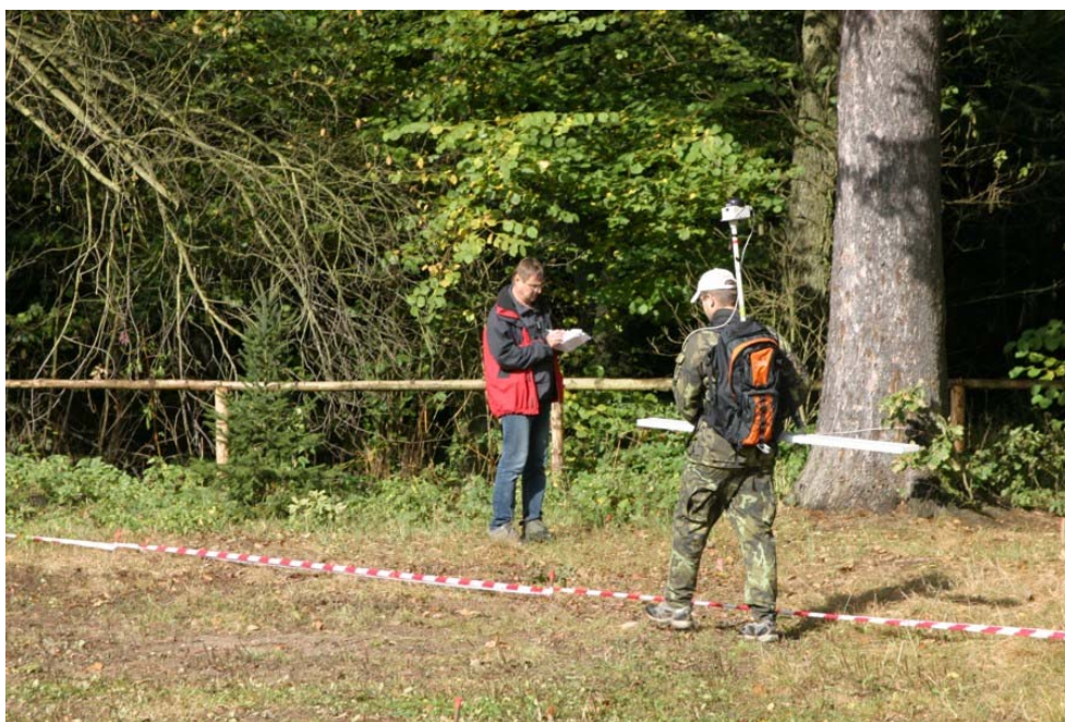
Elektromagnetická prospekce moderním dipólovým systémem měření přístrojem GEM-2.
